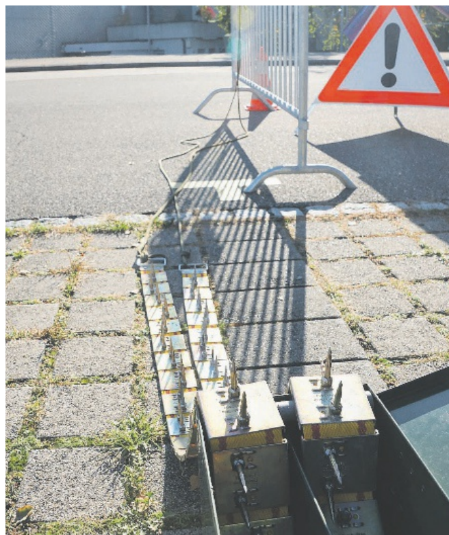
Solche Nagelsperren würden ein Fahrzeug im Notfall stoppen.
